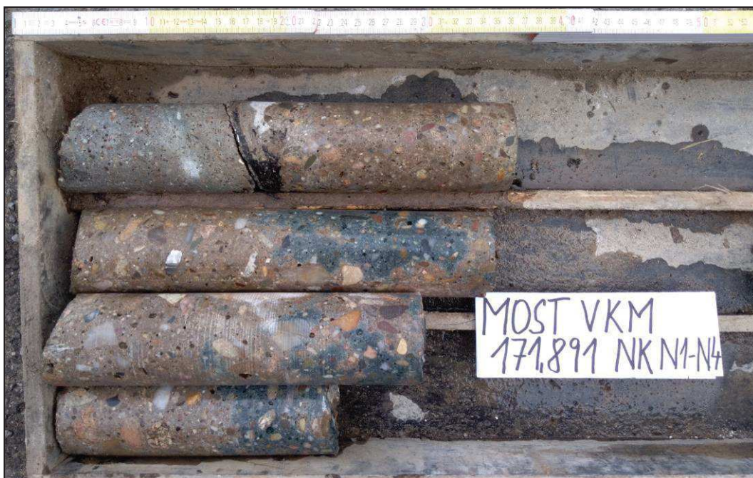
Obr. č. 1 - diagnostické návrtvy N1 – N4 do čela pravé části nosné konstrukce
