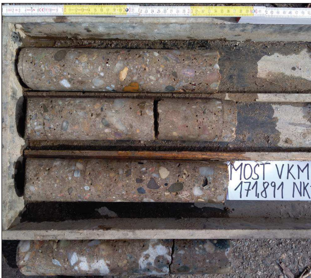
Obr. č. 2 - diagnostické návrtvy N5 – N8 do čela levé části nosné konstrukce
